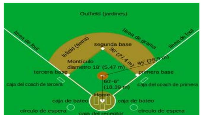
Para poder ubicar los montículos y las bases, se efectúa una fórmula de Pitágoras en donde se divide el cuadrado en dos triángulos, permitiendo una figura uniforme en la instalación de la cancha de béisbol.
