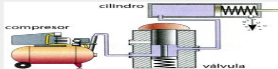
Es la tecnología que utiliza aire comprimido como medio de transmisión de la energía para mover y hacer funcionar mecanismos. Por ejemplo, las máquinas hidráulicas, las compresoras de aire, etc.
