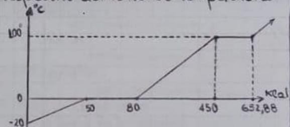
Entonces el calor latente de ebullición sobre el cuerpo es: A. 320 Kcal B. 30 Kcal C. 240 Kcal D. 202,88 Kcal
