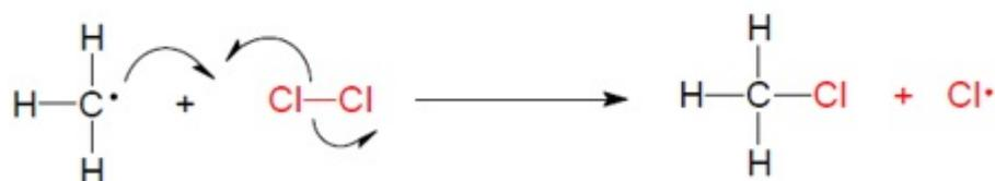
el anterior es el mecanismo de sustitución del hidrogeno del alcano por uno de los átomos de cloro.
