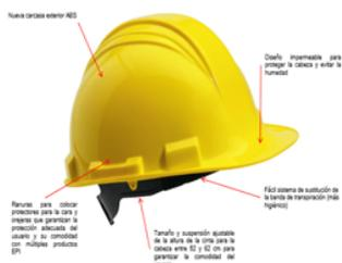
El casco debe ser dieléctrico (aislador), de fácil graduación y para trabajos en alturas llevará, además barbiquejo (cinta adherente) para evitar la caída del casco. La duración se calcula en 10 años dentro del almacén y dos a partir de la fecha de entrega del elemento, por lo cual es importante registrar la fecha de entrada al almacén y de entrega al trabajador.
