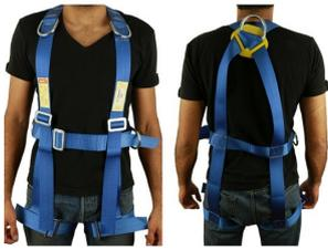
El arnés de seguridad es todo un sistema de protección compuesto por correas autoajustables y cintas para los hombros, con el fin de proteger todo el cuerpo y así detener la caída libre severa del trabajador. En caso de sufrir este tipo de caída, las cargas generadas al detener la caída se distribuyen a través de todo el cuerpo de tal manera que el cuerpo del trabajador no sufra con el impacto. Su uso es obligatorio para todas las personas que trabajen en alturas mayores a 1,80 m.
