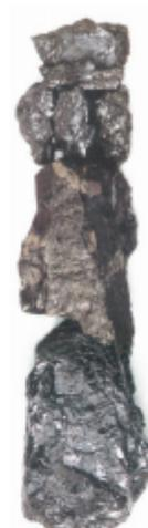
**Figura 9.** La antracita es un carbón fósil que, debido a su larga evolución, es una fuente muy apreciada de energía, pues desprende mucho calor y poco humo.
