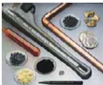
▲ Figura 2.17 Algunos ejemplos conocidos de metales y no metales. Los no metales (abajo a la izquierda) son azufre (polvo amarillo), yodo (cristales oscuros y brillantes), bromo (líquido marrón rojizo y como vapor en la ampolla de vidrio) y tres muestras de carbono (polvo negro de carbón, diamantes y grafito en la mina de lápiz). Los metales están en forma de una llave de tuerca de aluminio, una tubería de cobre, municiones de plomo, monedas de plata y pepitas de oro.
