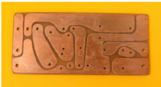
Figura 3, 1 Placa de circuito impreso elaborada con la técnica de planchado
