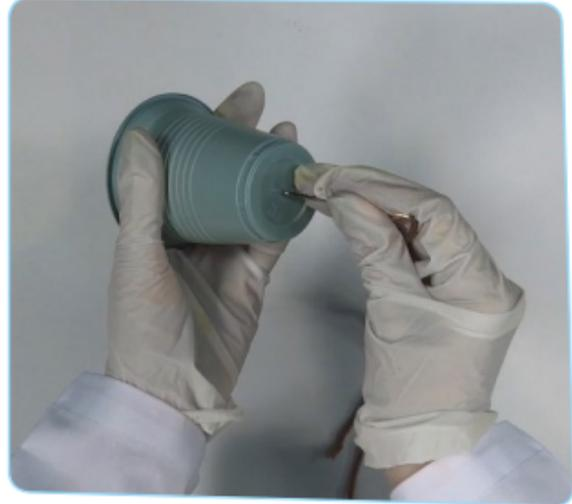
**Paso 3.** Sin desenhebrar la aguja, abre un hueco en la base del segundo vaso como se muestra.
